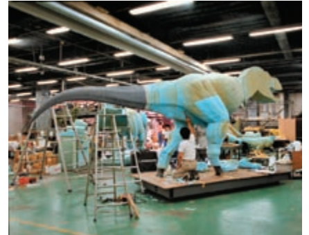
恐竜ロボットの製造現場。1体1体が異なる仕様になる上、完成までに長いサイクルとなるため、工程管理が重要なカギとなる
